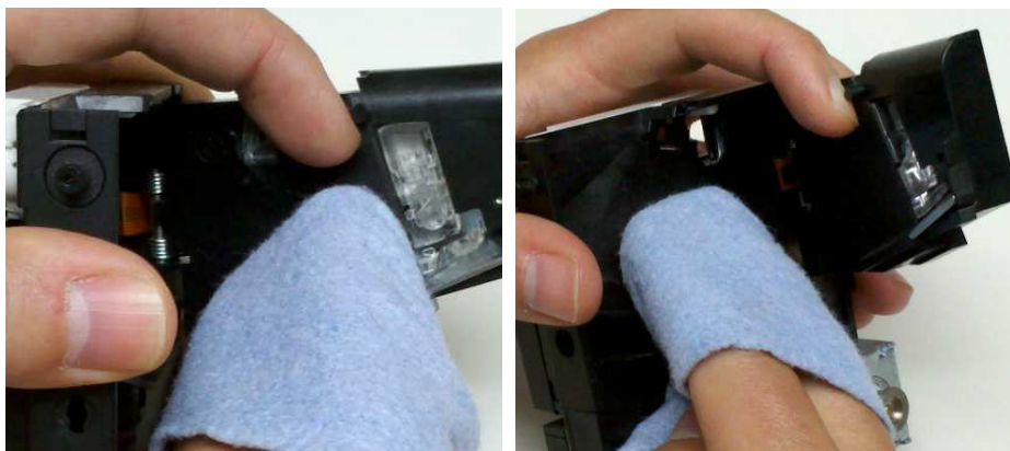
Bild 3: Reinigung der Klappe und der Laufschiene des EMP 800 v6 mit einem weichen Lappen
