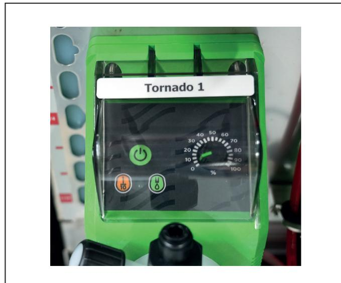
Abb. 4 - 9 Regler für Betriebseinstellung Dosierpumpe Tornado-Reinigungsdüse
